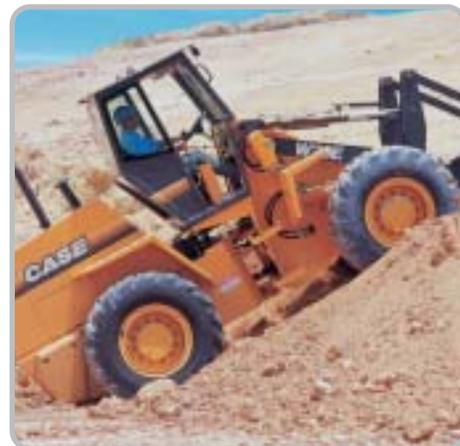
À prova de capotamento, a cobertura R.O.P.S. garante maior segurança ao operador. O limpador de pára-brisa, fixado na parte superior da R.O.P.S. e diretamente na estrutura, aumenta a visibilidade e o conforto.
