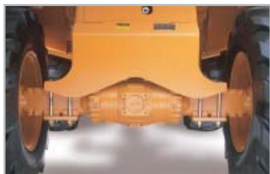
O eixo power lock reduz o arraste e a patinagem das rodas, aumentando a vida útil dos pneus. Além disso, o equipamento proporciona maior capacidade de tração em situações de pouca aderência.
